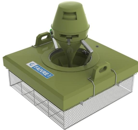
Der Flobull Belüfter projiziert einen stark emulgierten Wasserstrahl in die Luft und sorgt so für maximalen Kontakt zur Atmosphäre. Auf diese Weise wird Sauerstoff in der Luft in das Wasser übertragen. Dieser Prozess erhöht die Wassertemperatur nicht, da ein teilweise wärmerer Luftkontakt durch Abkühlung durch Verdampfung kompensiert wird.
